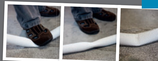
Mit wenig Druck ließ sich das flexible Rohr zusammendrücken. Der entstandene Knick bleibt.
